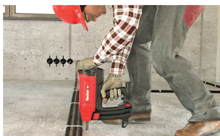
Elektromos csatlakozások minden irányba történő rögzítéséhez pl. vezetékek, csövek és elektromos kábelek a padlón, a falakon és a mennyezeten
